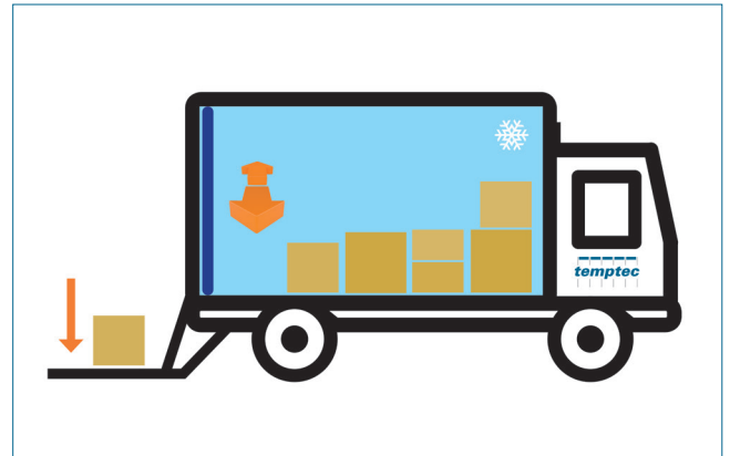
Abb. 5: EVO.TS, vollautomatisch, Schließimpuls über Ladebordwand
